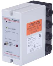
nVent RAYCHEM TraceTek TTC-1 模块适用于任何 TraceTek 传感电缆，传感电缆最长可达 76 m (250 ft)，通过红色 LED 灯和继电器触点指示泄漏检测。它非常适合集成到大型设施的集中式监控系统中。典型应用包括监控各个设备的泄漏，例如空气处理装置、水冷机械、单罐、泵、集水坑，或使用单根 TraceTek 传感电缆的其他位置。
