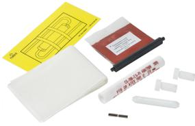
nVent RAYCHEM CS-150-xx-PI 是一系列用于聚合物绝缘 (PI) 串联加热电缆的薄型、低绝缘电源连接或接头，使用双组分硅酮化合物提供耐用和灵活的防潮封装。有 3 种型号，可实现高达 125A 的坚固可靠连接，并经批准可用于危险区域。内部电气连接由镀镍压接，专门设计用于极宽温度范围内提供可靠的电气连接。
