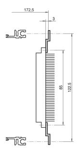
适用连接器的 Z 形导轨,符合 DIN 41617 标准,31 针。
