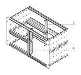
支撑装置用螺栓固定在水平横梁的网格孔中,可将 6 U 插箱拆分为 2 x 3 U 部分。
