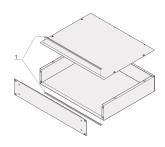
EMC 屏蔽套件和盖板可将机箱屏蔽能力从大约 30 dB(A) 提高到大约 60 dB(A)。可以下载测试报告。
