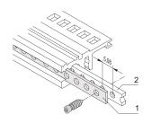
用 1mm 铝材制成的通孔条,适用于为屏蔽型插入装置确定中心。
