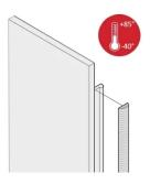
导电布 EMC 屏蔽条,可插入 U型前面板右侧的插槽。屏蔽条将粘在前面板上。适合高达 +85℃ 的宽温环境。
