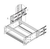
适适配后部固定的转接件,可根据 DL3 标准将插箱固定在机柜中。可保证抗冲击性和抗振动性高达 25 g。
