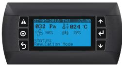
该显示屏模块可用于对 RackChiller Rear Door 进行本地配置、调试和监测。包含一个 LCD 面板显示屏和 6 个功能键。直接安装在冷却器的外部面板上，并连接至装置内预先布设的电缆。
