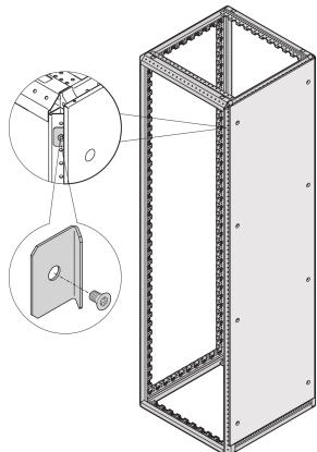
内部固定器易于安装，无需钻孔，使得侧面板只能从内部拆卸。此固定器仅适用于 IP 20 应用。
