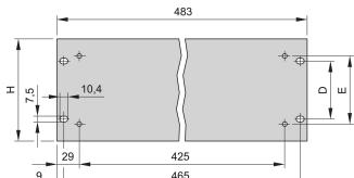
使用 SCHROFF 19" 前面板定义设备前面和侧面。SCHROFF 19" 带有额外的把手安装孔，尺寸为 1 U 至 6 U。
