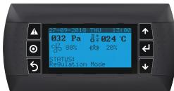
该显示屏模块可用于对 RackChiller Rear Door 进行本地配置、调试和监测。包含一个 LCD 面板显示屏和 6 个功能键。直接安装在冷却器的外部面板上，并连接至装置内预先布设的电缆。
