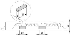
适用于母线的绝缘块，防止端子意外短路和损坏。绝缘块可提供刚性支撑，以物理方式将机架母线与所有电源输入分隔开，便于安装母线。
