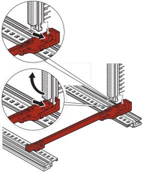
带连接器固定件的标准型导轨有助于用户将 DIN (EN 60603-2 (DIN 41612)) 连接器直接夹在导轨上。仅适用于尺寸为 100 x 160 mm 和 100 x 220 mm 的欧洲规格电路板。适合 RatiopacPRO/-AIR、PropacPRO、CompacPRO 和 EuropacPRO。
