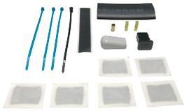
RAYCHEM WinterGard H910 接头和三通套件适合与 WinterGard 自调控伴热线搭配使用，实现拼接、三通和尾端连接。此套件包含一个接头和一个端部密封，或一个 T 形连接和一个端部密封。此套件不提供电源连接；使用 H900 或 H908 电源连接套件可实现完整安装。
