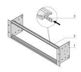
用于根据 DIN 43880 安装安装设备, 尺寸 1-
