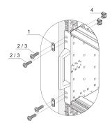
用于将带双固定孔的插箱固定在 19" 安装支架上(例如,加固型插箱和铁路插箱)。
