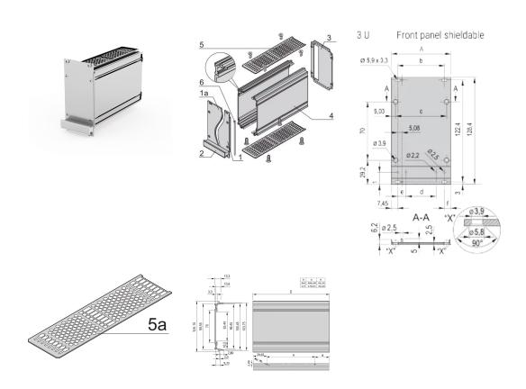
防止 PCB 遭受机械损坏和静电放电积聚;适用于欧洲板规格;与带一个开孔(用于一个连接器)的面板搭配。
