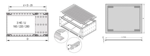
盖板用于提供电磁屏蔽或机械保护。盖板可用于装配到插箱中的非标准板卡。
