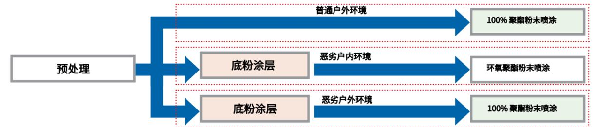
nVent HOFFMAN对机柜及其附件的粉末喷涂提供定制服务，还有多种颜色以及各种纹理供您选择，下表总结了更为详细的粉末材质和喷涂方式：
