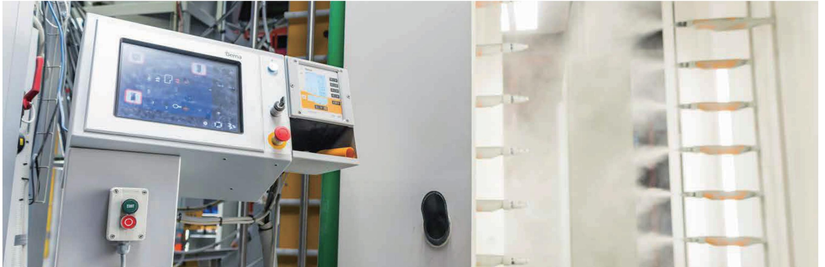
nVent HOFFMAN 采用粉末喷涂工艺来保护机柜表面免受腐蚀、刮擦和老化等环境因素的伤害。粉末涂料具有较好的涂层性能，如较好的附着力，避免溶剂型涂料的不平衡性造成的涂层缺陷等。粉末涂料可控制成膜厚度、饰面更耐用，涂层种类更多，可用于功能定制或装饰饰面定制。一般来说，粉末涂料具有易于使用、耐腐蚀、经济实惠且环保等特点。在上述几方面，粉末涂料是优于溶剂型涂料的。
