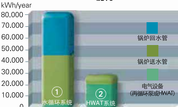
HWAT系统的能耗仅为水循环系统的36%
