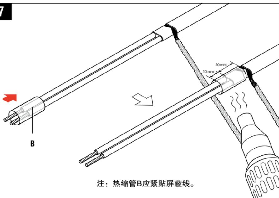
注：热缩管B应紧贴屏蔽线。
