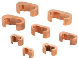
nVent ERICO压接连接器 - E型压接紧固夹，属于nVent ERICO压接接地连接器系列。E型压接在接地系统中通过压缩工具将两根导线连接起来，适用于较大截面的导线。E型压接紧固夹由高强度导电铜制成。这可确保低电阻特性，避免受到腐蚀影响，从而延长使用寿命。为了防止氧化，E型压接预先填充了氧化抑制剂，一旦完成连接，就会在导线周围形成气密层。这使得E型压接连接器适用于多种应用场景。E型压接连接器标有公制和AWG两种导线规格，可在各种气候条件下安装。
