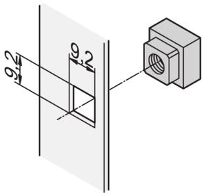
四角螺母的接触面更高，而且不会像六角螺母那样被磨圆。要实现精确、无扭曲、安全且无间隙的安装，请使用四角螺母。
