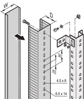
机柜侧面和后面区域的电缆管道，可安装在机柜立柱、埋深构件或 C 形型材上。
