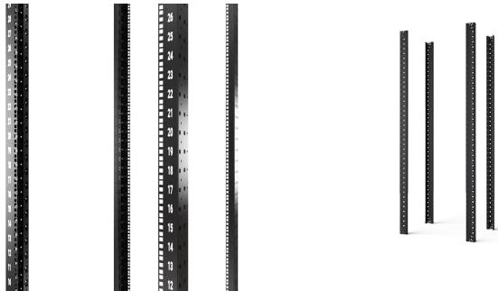
19"面板/滑轨安装轨，深度安装方向依照25mm增量调节。直接装配在 600 mm宽的机柜框架中。在 800 mm宽度机柜内，需要减少宽度的转接支架，对于部分高度安装，需要深度构件。
