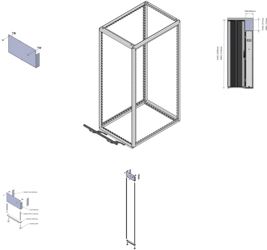
RackChiller 直排式机械连接套件可用于将冷却器集成至 Proline 或 Varistar 通道系统。包括调平支脚、底座和顶部挡板，可确保外观完美，同时提供最出色的通道系统密封属性。该套件提供不同的变体，具体取决于所用的冷却器和机架。
