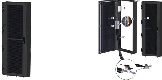
RackChiller Rear Door 冷却器 (RDC) 水冷热交换器适合管理高密度服务器、计算和存储机架内的高热负荷冷却需求。RDC 以带额外框架的独立后门形式安装在设备机架上，因此可针对现有机架进行改装。通过机架设备散出的热量将被空气-液体热交换器去除，然后传输到设施水回路，不会对 IT 机房增加任何热量。整个系统集成在框架美观的网孔门内，带有可将液体源和冷却回路与机架设备隔离开的保护盖。
