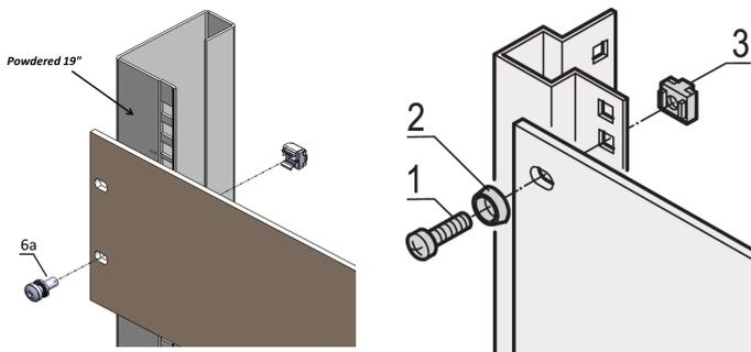
如需标准接地, 请至少在一个连接点处使用接地螺母和垫圈。
