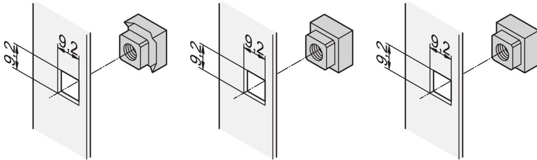
四角螺母的接触面更高，而且不会像六角螺母那样被磨圆。要实现精确、无扭曲、安全且无间隙的安装，请使用四角螺母。
