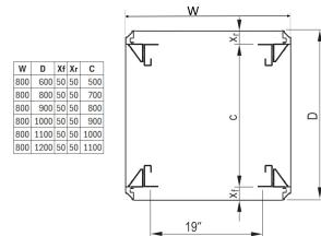
符合静态承载要求的 Varistar 钢制框架。适用于 19" ETSI 或安装板集成。
