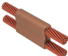
重负荷连接最初开发用于回收的电缆。重负荷连接在模具中使用较大尺寸的连接腔，并且相比于等效标准负荷连接需使用更大尺寸的焊药。
