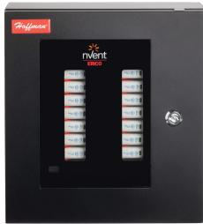
nVent ERICO DTX240 系列浪涌保护装置 (SPD) 符合北美和全球标准，可针对破坏性瞬态和浪涌电流提供出色保护，尤其适用于 IEC I 类和 II 类及 UL 1 类和 2 类场所。该装置设计新颖，可安装在配电盘的线路端或负载端，无需断路器（仅限 B 版本）。DTX240 具有每相 240 kA 的浪涌额定值，非常适合用于 C 类安装位置。通常用于检修入口、配电设备、分支面板、电机控制中心 (MCC)、照明面板和暖通空调 (HVAC) 等。此外，nVent ERICO DTX240 还具有 NEMA®-4X 防护等级，适合户外应用。
