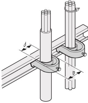
C 型导轨可实现更出色的电缆管理。通常安装在 19" 立柱后面。它们与标准电缆夹兼容。
