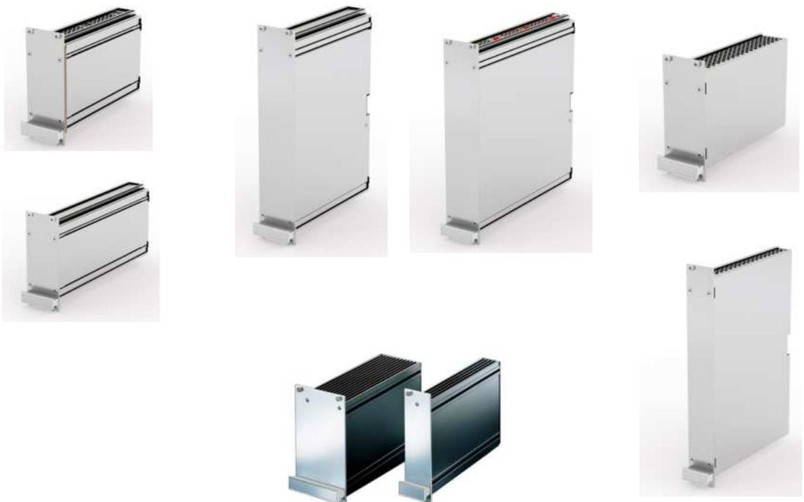
Les cassettes 19" sont des éléments mécaniques destinés à recevoir une ou plusieurs cartes électroniques, constituant ainsi des modules fonctionnels normalisés. Les dimensions mécaniques sont conformes aux normes CEI 60297-3-101 et IEEE 1101.1/11 qui définissent le standard 19". Ces modules fonctionnels sont intégrés dans des bacs à cartes ou coffrets dont les dimensions sont également conformes aux normes CEI 60297-3-101 / IEEE 1101.1/11.
