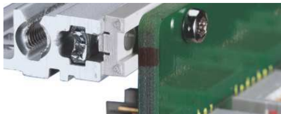
Modulschiene hinten zur Backplanemontage mit Isolierstreifen
