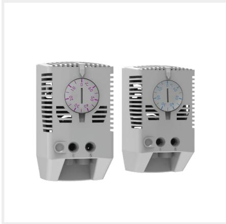
**Descrição:** Termostato com NF / contatos para controlar a temperatura. ETR202 com um contato normalmente fechado para regular resistências . ETR201 com um contato normalmente aberto para regulamentar os dispositivos de arrefecimento ou dispositivos de sinalização. Sensor elemento bimetálico termostática. Clip de montagem de 35 milímetros em carril DIN (EN 60715).
