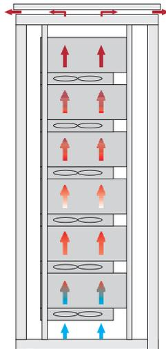
Durch vertikale Luftführung erwärmt sich die Luft kontinuierlich nach oben.
