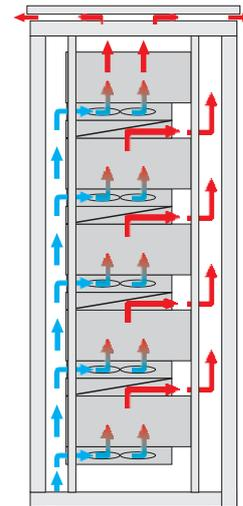
Durch Verwendung der 1 HE Luftführung erfolgt die Luftzufuhr von vorne und die Abluft nach hinten. Somit erhalten alle Baugruppen die gleiche Kühllufttemperatur zugeführt.
