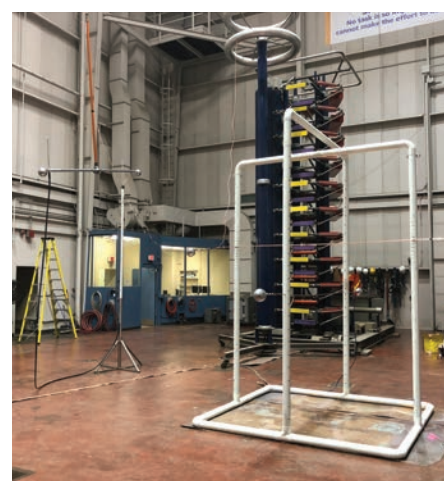
Test di laboratorio per verificare la distanza di separazione equivalente, cavo e palo indipendente inclusi
