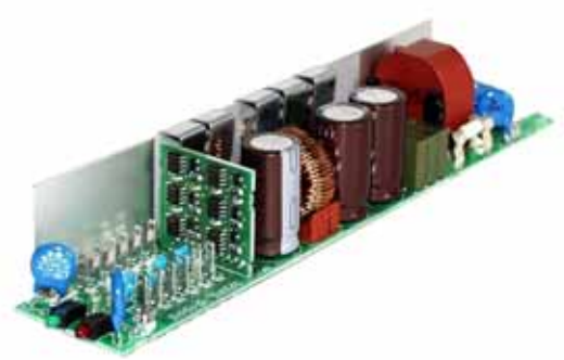
Convertisseur DC/DC pour ventilateurs (avec surveillance)
