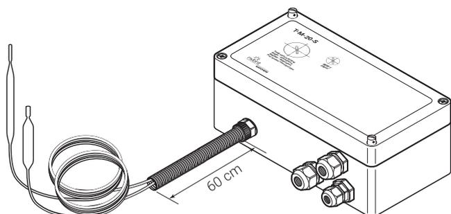
Les thermostats de contrôle sont conçus pour réguler et limiter la température en zones sûres. Si une défaillance du système de contrôle survient ou que la température augmente anormalement, un système disjoncteur empêche que le système de traçage dépasse la température maximale prédéfinie.
