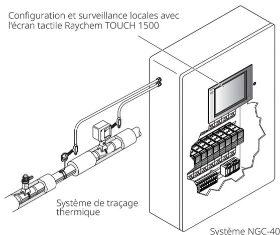
Le Raychem NGC-40 est un système de régulation, de surveillance et de distribution électrique pour les applications de traçage multipoints. Bénéficiant d'une architecture exceptionnelle de régulateur à point unique, il fournit la solution de régulation et de surveillance centralisées la plus fiable du marché pour votre système de gestion thermique.
