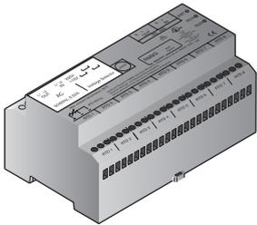
Le NGC-40 fonctionne avec le module MONI-RMM3. Chaque module RMM3 installé sur site admet jusqu'à 8 sondes. Il est possible de connecter en série jusqu'à 16 modules RMM3 au moyen d'un câble RS-485 pour obtenir un total de 128 entrées de température. Étant donné que plusieurs modules RMM3 peuvent être mis en réseau à l'aide d'un seul câble jusqu'au système NGC-40, le coût du câblage des sondes s'en trouve considérablement réduit.
