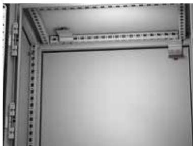
La plaque de M.A.L.T. permet de raccorder efficacement les panneaux ProLine ou ProLine G2 au cadre. L'ensemble se compose d'un support conçu pour la mise à la terre du panneau arrière, d'un jeu de supports pour la mise à la terre des panneaux supérieurs et latéraux, et de la quincaillerie pour fixer les supports au cadre. Les supports sont fabriqués en acier inoxydable 304 de calibre 24.
