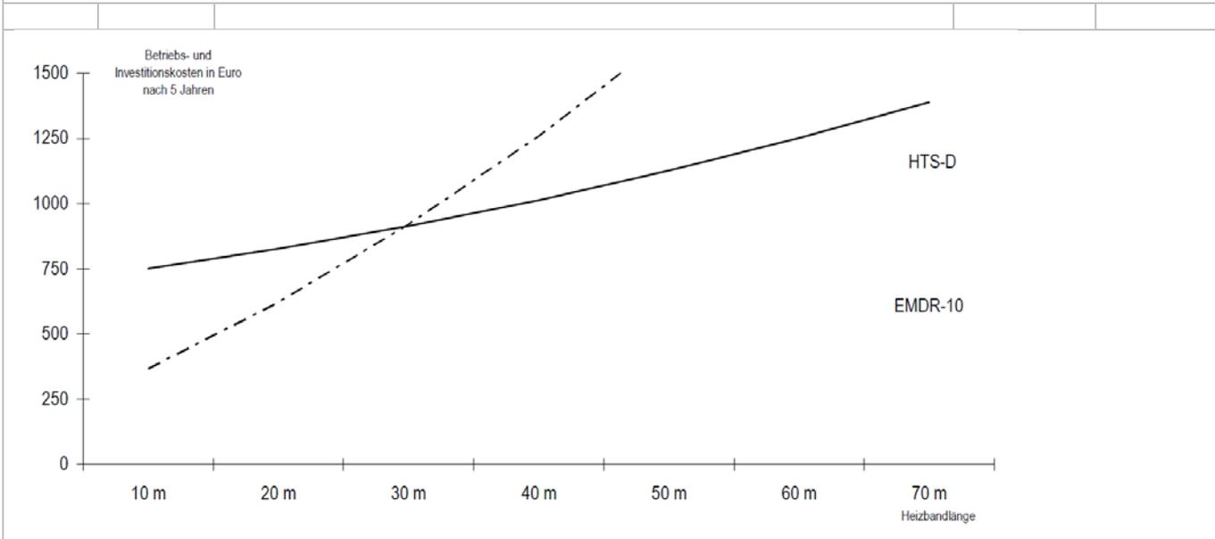
Diese Grafik zeigt den wirtschaftlichen Einsatzbereich der beiden Steuerungen HTS-D und EMDR-10. Es ist zu erkennen, daß bis 30 m Heizbandlänge der Doppelpunktthermostat HTS-D und ab 30 m Heizbandlänge das Steuergerät EMDR-10 die wirtschaftliche Lösung ist.
