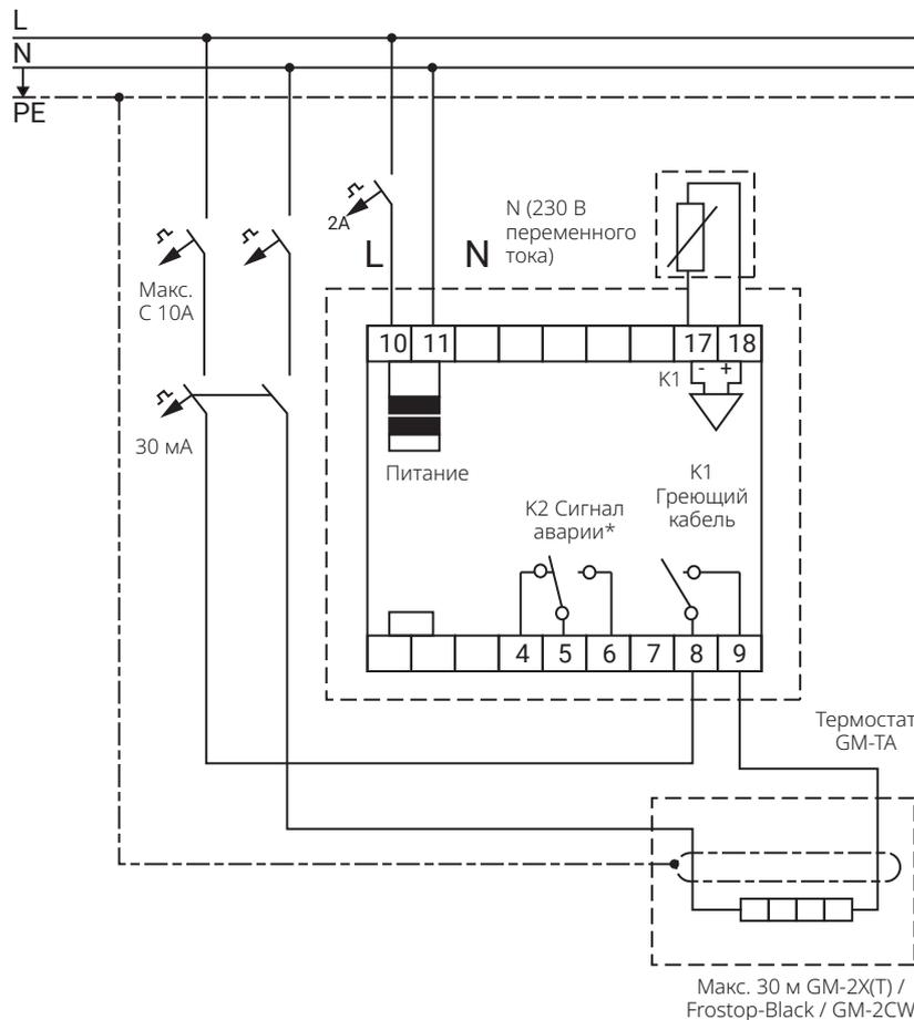
\*Сигнал аварии находится в положении 5-6, если контроллер получает питание и отсутствуют сбои.
