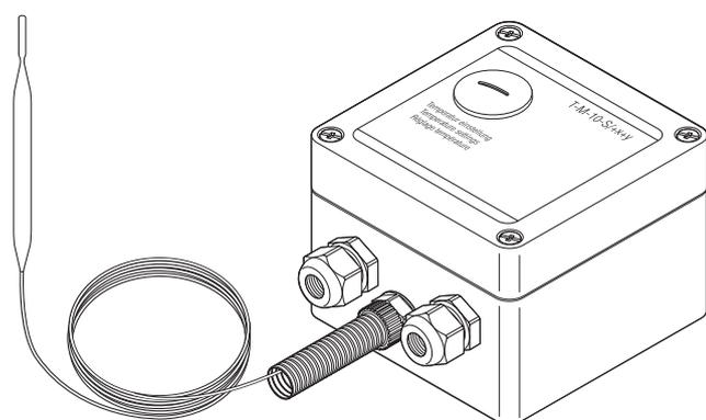
Термостат для регулирования обогрева по температуре обогреваемой поверхности nVent RAYCHEM T-M-10-S/+x+y предназначен для использования в нормальных (невзрывоопасных) зонах. Задание уставки может быть выполнено без вскрытия термостата через заглушку на крышке. Двухметровая капиллярная трубка из нержавеющей стали у вывода из корпуса термостата защищена гибким кожухом.
