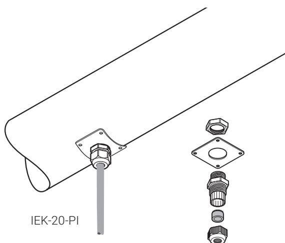
Les kits d'entrée de calorifuge sont conçus pour protéger les câbles à l'endroit où ils traversent le revêtement du calorifuge.
