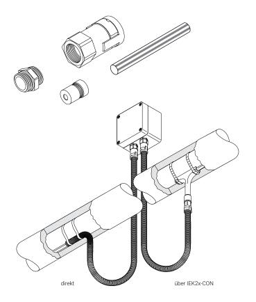
Diese Anschlussgarnitur ermöglicht den Anschluss sämtlicher polymerisolierter Heizkabel der Reihe nVent RAYCHEM XPI und dazugehöriger Kaltleiter an einen der Anwendung entsprechenden Anschlusskasten und stellt gleichzeitig eine zuverlässige, dichte Verbindung zu einem Schutzschlauch-System sicher.
