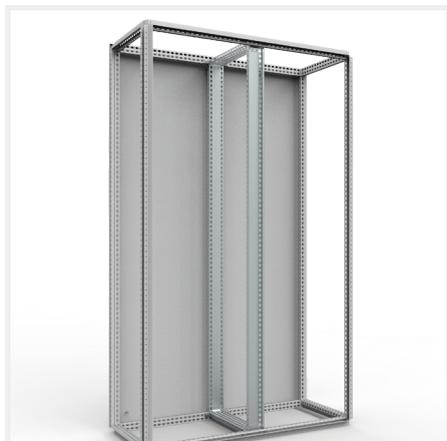
**Beschreibung:** Senkrechte Profilschienen für die mittige Teilung von 1200 und 1600 mm breiten Schränken, um die gleichen Montagemöglichkeiten wie in zwei 600 und 800 mm breiten Schränken zu erhalten. Erlaubt den Einbau von Schwenkrahmen, Montageschienen usw. in jeder Seite.
