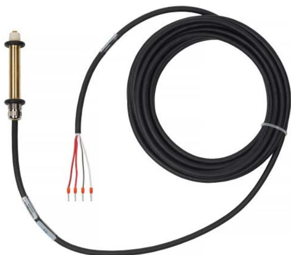
Sensore a stelo E650C-R per la misurazione combinata di temperatura e umidità in grondaie e aree adiacenti, come tetti piani e pluviali, da utilizzare con Elexant 650c-Modbus. Robusto sensore in ottone, completamente incapsulato. Design estremamente compatto con uscita cavo assiale e bullone filettato per il fissaggio in posizione.
